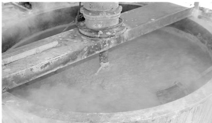
사진 5. 현대식으로 작목반 등에서 만드는 석회유황합제 제조 과정
