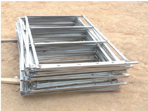
[그림 32] 문짝 프레임 제작
